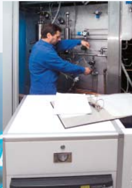
Vorbereitung von Validierungsläufen an einem Dampfsterilisator mit Beladegut
